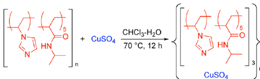
圖五 高分子銅錯合物結構與合成
